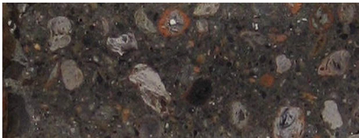
Fot. 3. Przekrój mrozoodpornego i szczelnego betonu LC27/30 D1,8
